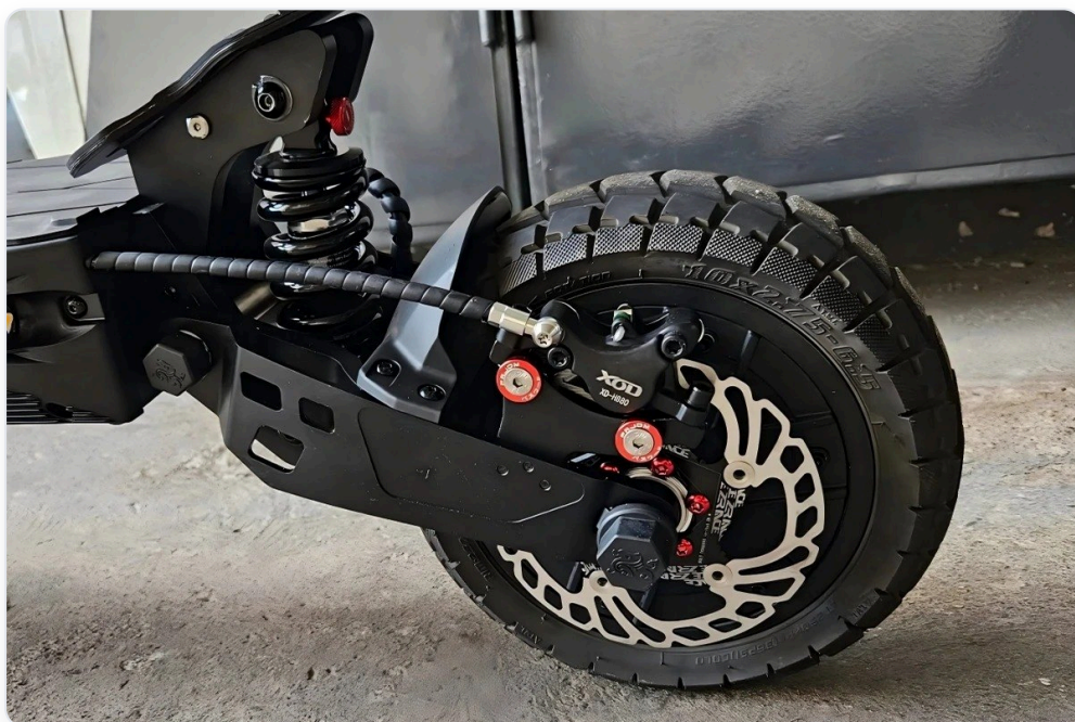
图 6 实拍核对 (后轮安装姿态)：卡钳从上方夹住碟片，油管接头朝上，与摇臂、轮毂之间留有可视间隙 —— 这正是后轮的标准安装姿态
