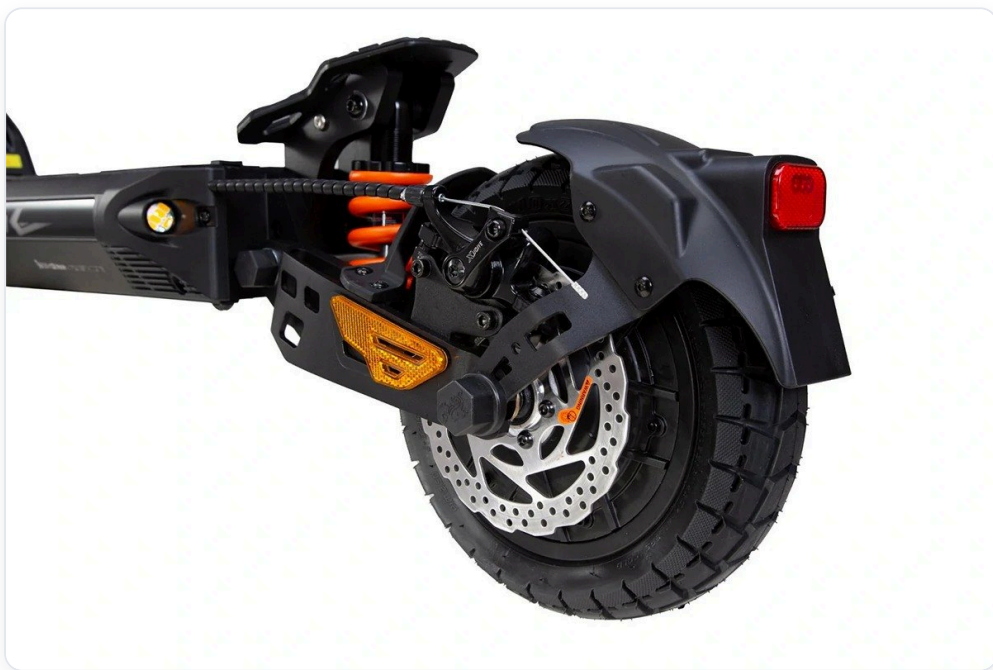
图 17 KuKirin G4 后轮实拍：卡钳装在轮子右侧，从上方夹住碟片 —— 对应 H800
