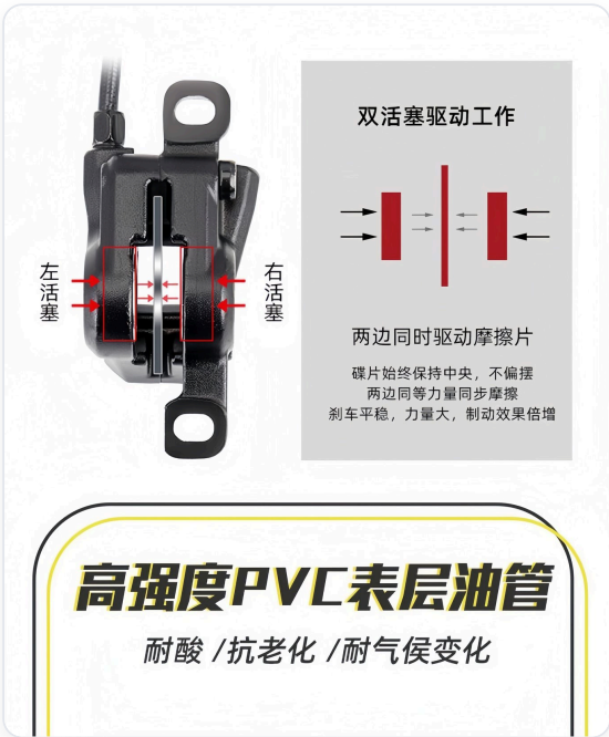
图 11 双活塞驱动工作原理与高强度 PVC 表层油管
