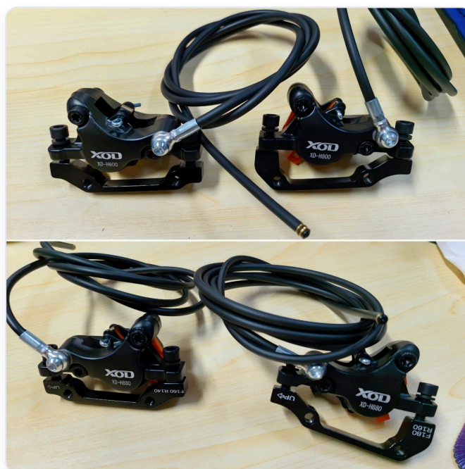
图 2 H800 与 H880 卡钳实物对照：上图为两只 XD-H800，下图为两只 XD-H880。注意支架上"UP"箭头方向与 F160 R140 刻字的相对位置——这就是两个版本的区别所在
