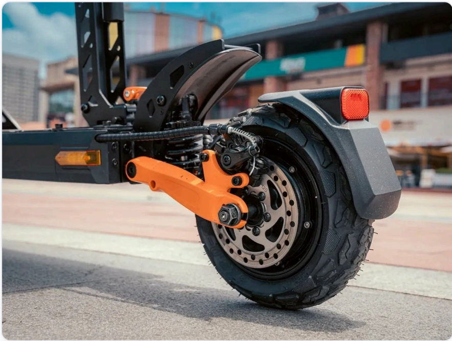
图 18 另一台同规则车型（KuKirin G2 Pro 后轮）：卡钳与碟片同在轮子 左侧 ，橙色摇臂托住 —— 同样适用"后轮碟片在左 → H880"
