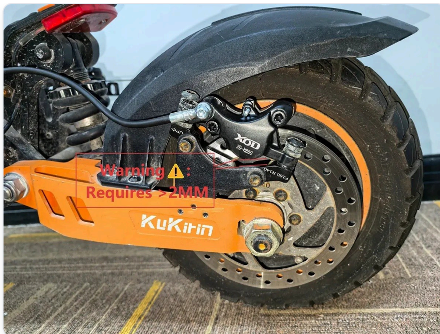
图 14 实拍警告 (KuKirin G2 Max · 橙色摇臂) : 卡钳刻字 XD-H880 / F160 R140, 摇臂上明确标注 Warning ! Requires >2MM —— 即卡钳底缘与摇臂间隙须 大于 2 mm
