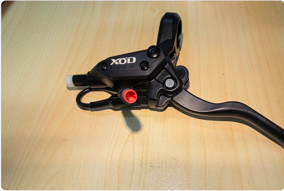
图 4 XOD 液压刹车把手：主体刻有 XOD / MINERAL OIL（矿物油）字样，含断电传感器接口与油管接头
