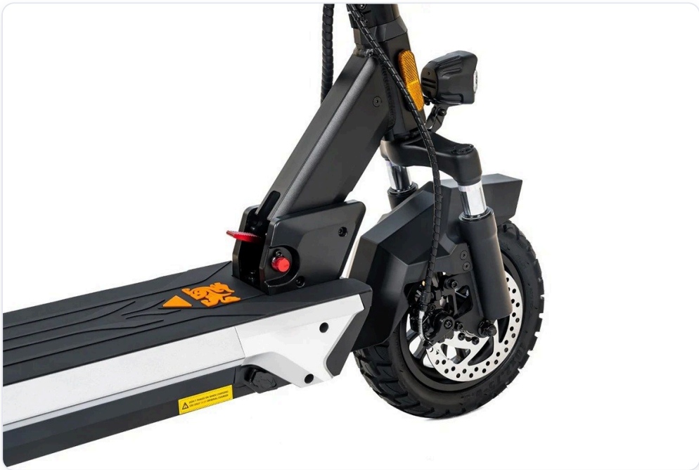
图 7 立式前叉实拍 (KuKirin M4 Max)：前碟片在轮子 右侧 ，卡钳安装于前叉 后方 （标准安装位）—— 对应 H800
