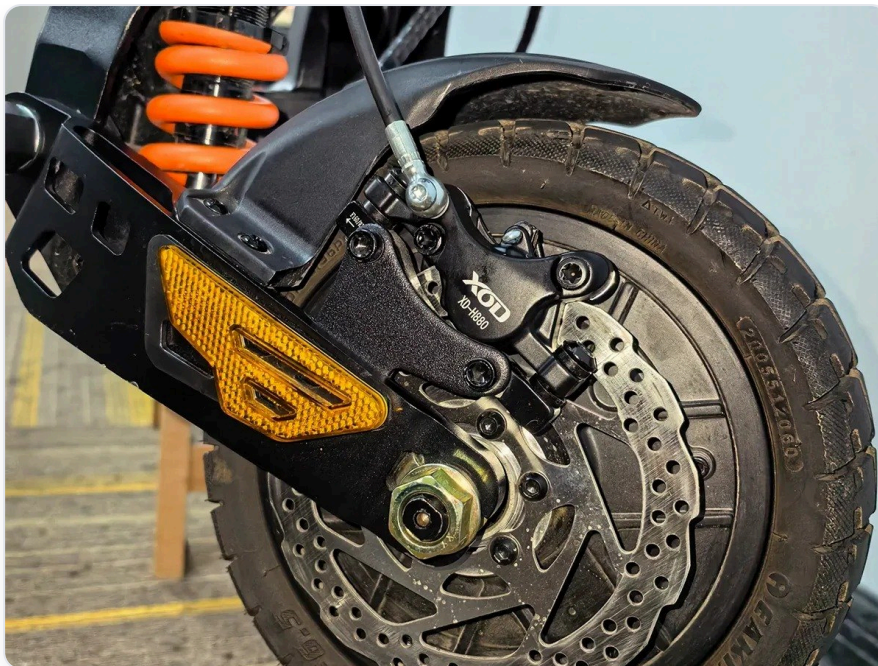
图 9 实拍核对 (KuKirin G2 Master 2025 · 前轮 · 单臂悬架)：卡钳位于轮子 右侧 ，刻字 XD-H880 ，悬架臂在下方 —— 与"单臂悬架 · 前碟片在右 → H880"一致。同一条"碟片在右"，前轮得 H880，可见前轮不能只按一侧硬套。
