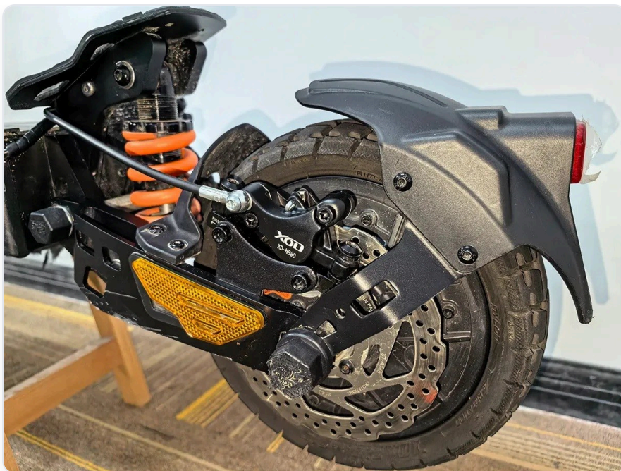
图 5 实拍核对 (KuKirin G2 Master 2025 · 后轮)：卡钳位于轮子 左侧 ，刻字 XD-H880 ，油管自上方接入 —— 与"后轮碟片在左 → H880"完全一致
