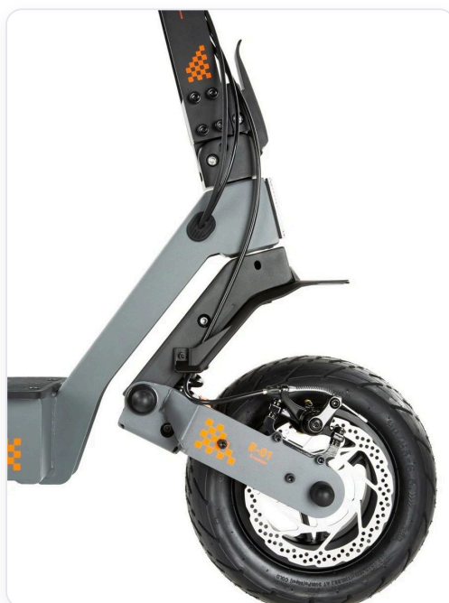
图 10 单臂前悬架结构细节 (KuKirin G4 前轮)：卡钳完全落在单臂摇臂内侧，碟片在轮子右侧面，油管沿摇臂走向接入
