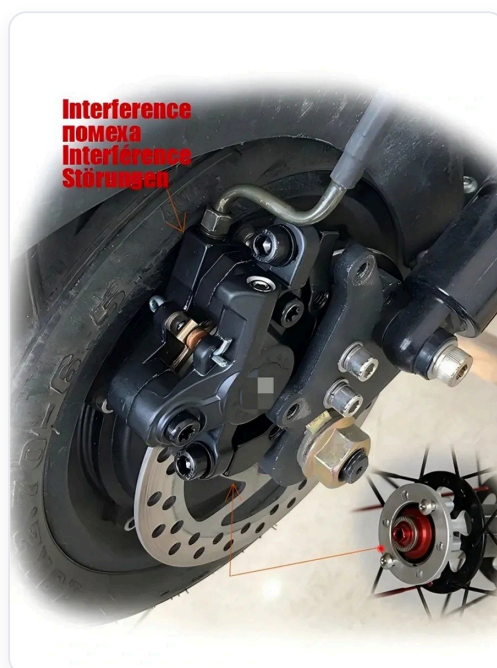
图 15 不加垫片时的干涉实拍：碟片 / 卡钳区域与轮毂支架距离过近（原图已用红字标注 Interference / 干涉 / помеха），需加装垫片垫开
