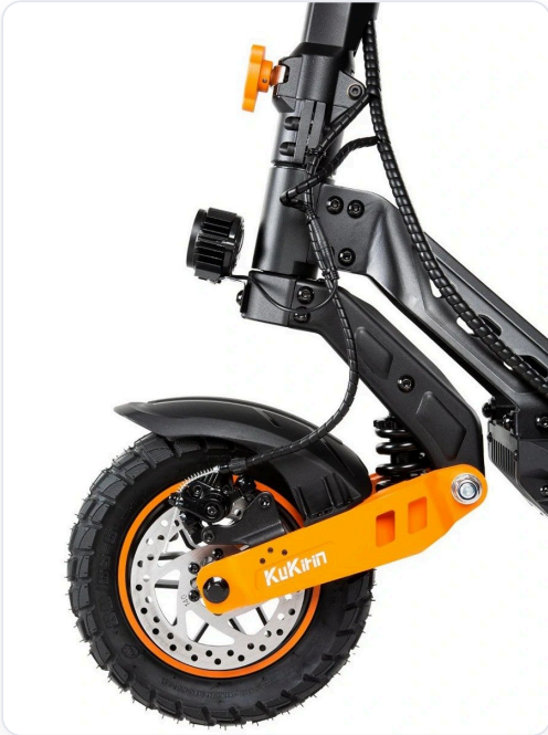
图 8 实拍核对（KuKirin G2 Max · 前轮 · 单臂悬架）：前碟片位于轮子 左侧 ，橙色单臂摇臂从上方压住，卡钳装在摇臂与轮毂之间 —— 对应 H800
