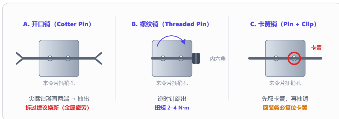
图 3 (S3 拆下固定件) 三种主流来令片固定形式。拆之前先看清是哪种，并按 拆卸的逆序 回装。
